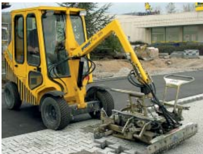
Einfaches Handling: Probst-Pflaster-Verlegemaschine VM 204 Robotec mit patentierter ADV-Technik. Alle Zangenbewegungen – auch die Verschiebung in den Läuferverband – werden SPS-gesteuert.
