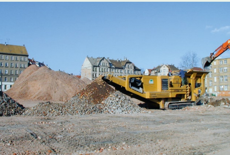
Bild links: Bauschuttrecyclinganlage im innerstädtischen Einsatz Bild unten: Baufeldfreimachung, Start- und Landebahn Süd Flughafen Leipzig-Halle
